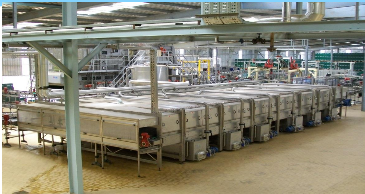
Pastorizzatore Modello 15,5-6-6 Produzione 25.000 b/h birra
