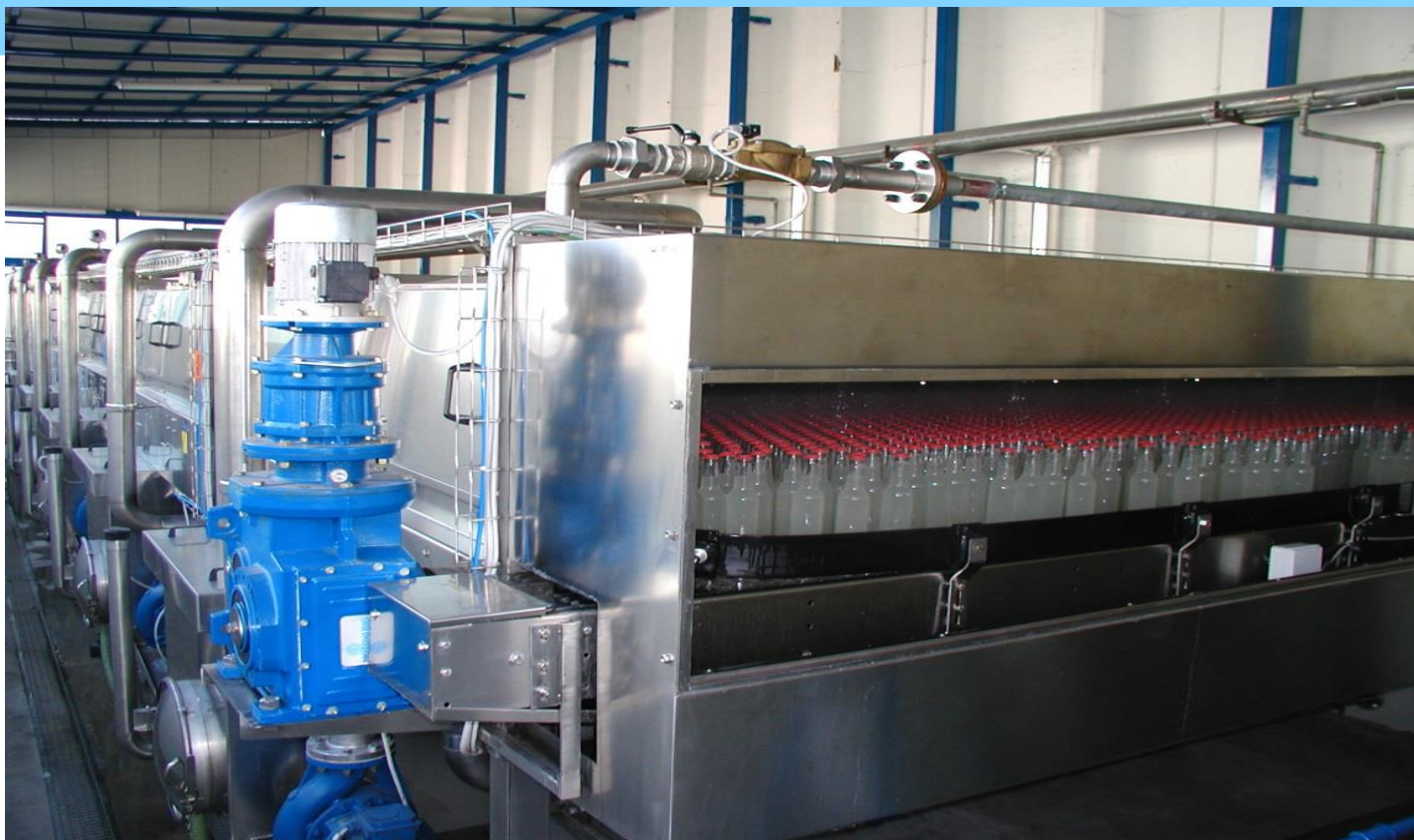
Pastorizzatore Modello 17,5-4-7 Produzione 25.000 b/h BIBITE
