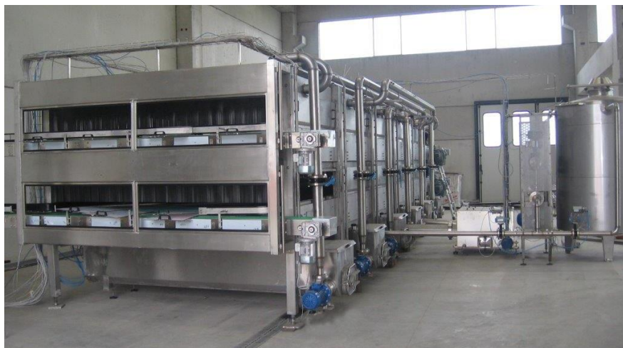
Pastorizzatore Modello 12-3.2-6-2 Produzione 25.000 c/h birra
