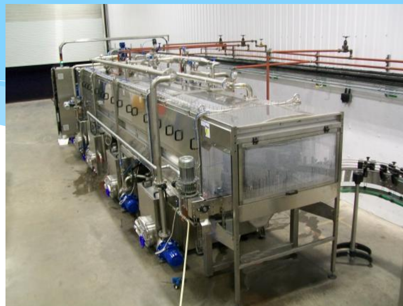
Pastorizzatore Modello 8-1-4 Produzione 2.500 b/h soft drink
