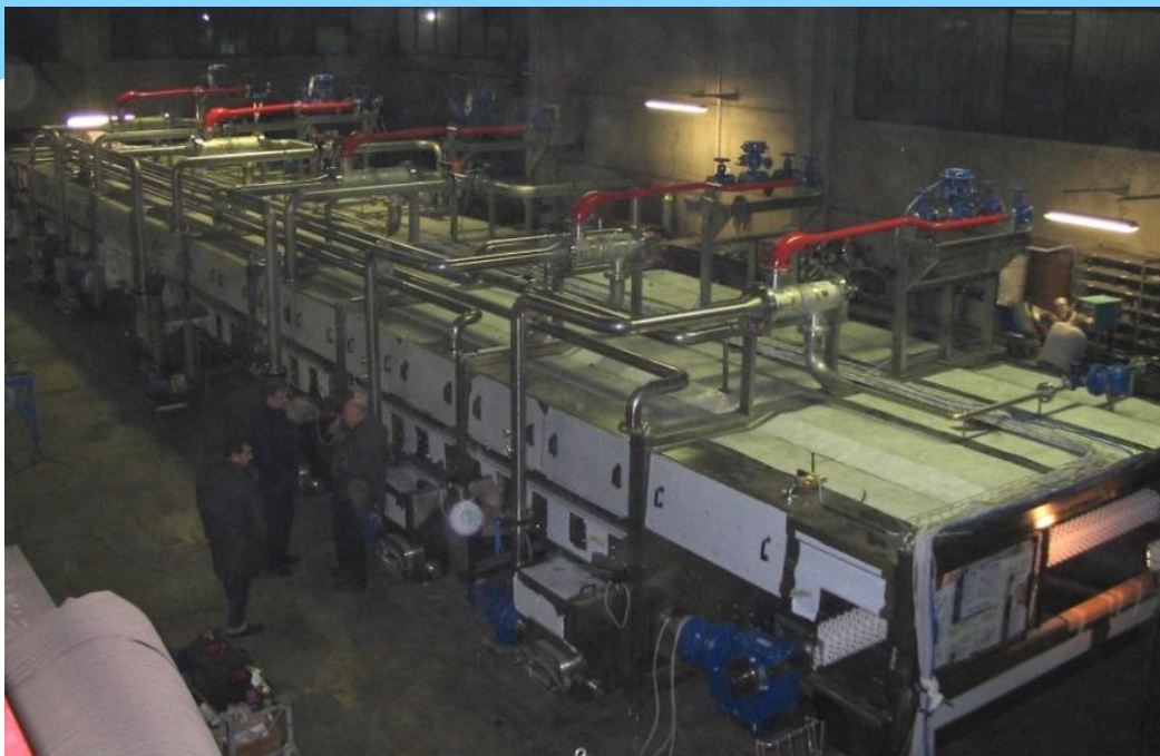
Pastorizzatore Modello 24,5-4-6 Produzione 36.000 b/h bibite
