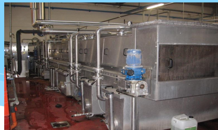
Pastorizzatore Modello 9-2-6 Produzione 3.500 b/h vino
