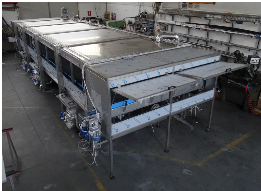
Sterilizzatore Modello 4-2,5-3 Produzione 6.600 b/h Ketchup Salse con verdure
