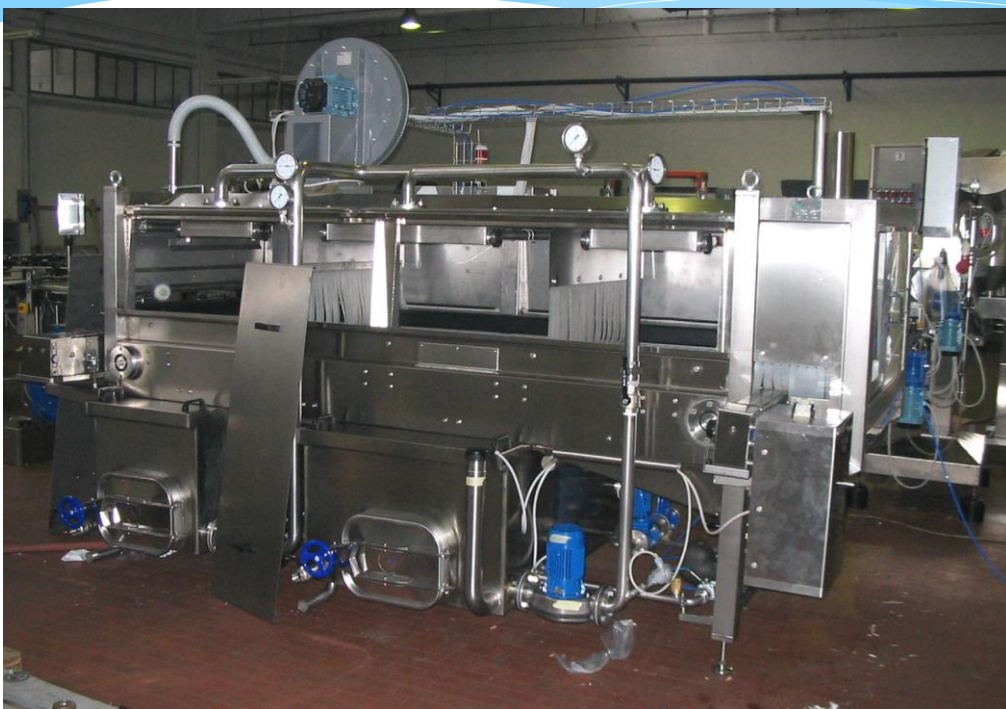
Sterilizzatore Modello 3-1-2 Produzione 3.000 v/h miele
