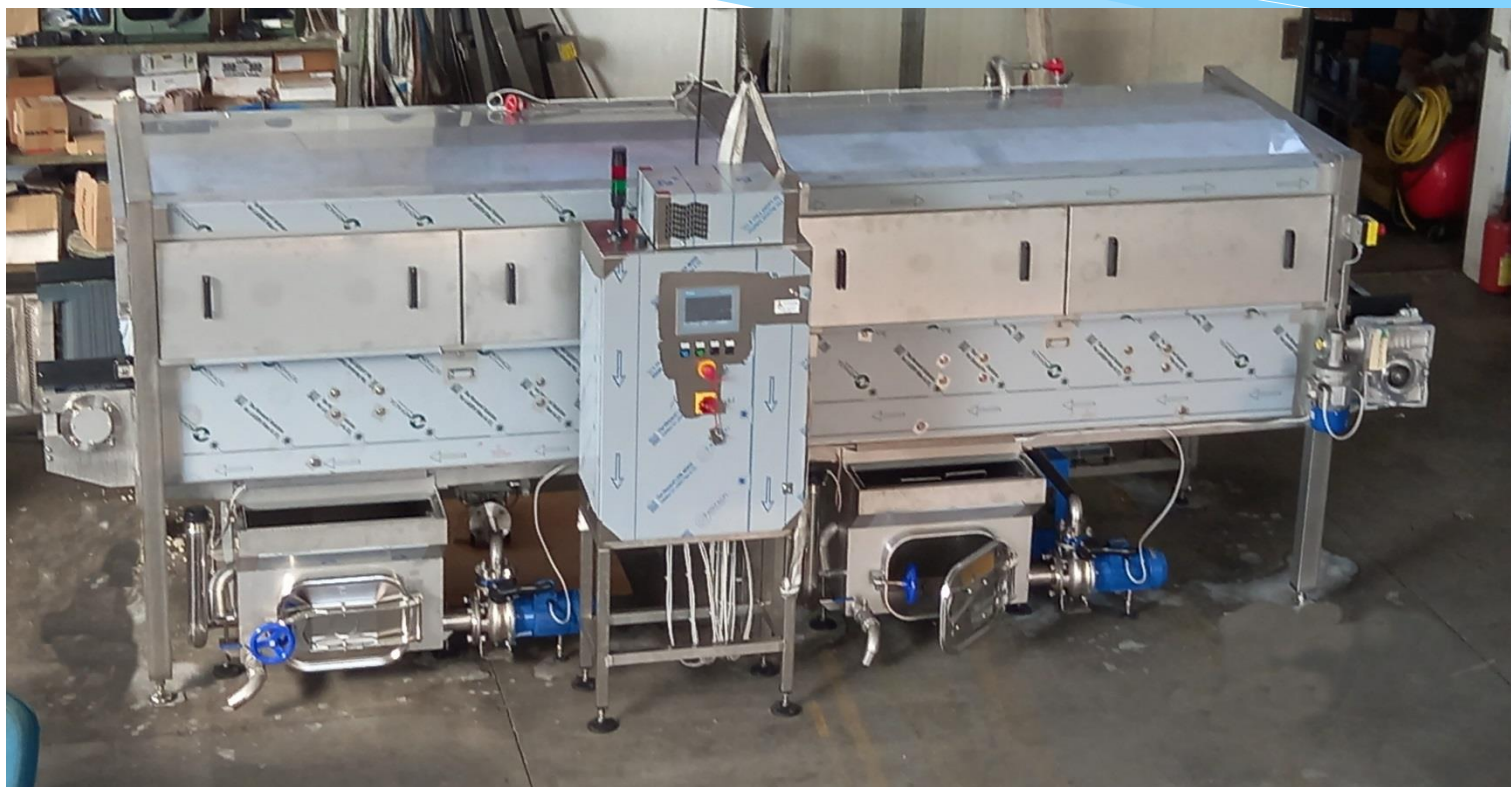
Sterilizzatore Modello 2-1-2 Produzione 3.600 b/h Succhi di frutta Succhi di pomodoro
