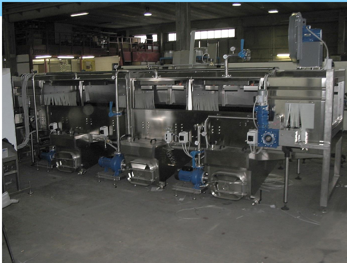
Sterilizzatore Modello 4,5-1-3 Produzione 2,500 b/h Ketchup
